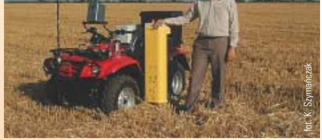
Fot. 2. Zestaw do mechanicznego pobierania próbek glebowych sterowany GPS, wydajność dzienna — do 200 ha
